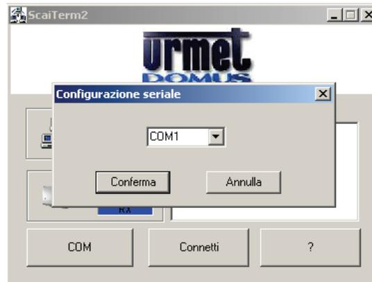
Da quest'ultima finestra è possibile verificare e scegliere la porta del PC su cui è connesso il centralino tramite convertitore e con il pulsante **Connetti** della finestra del server è possibile effettuare la connessione manuale. Se, una volta effettuata questa operazione, si presenta il seguente messaggio di errore:
