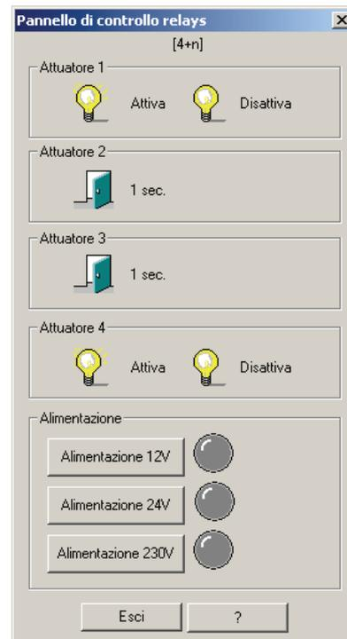
Nella seconda finestra, dal titolo **Pannello di controllo relays**, si possono comandare il relè attuatore presente sulla base e i 3 presenti sulle diverse schede citofoniche per come si sono programmati nella finestra precedente. Inoltre è possibile effettuare un test sulle alimentazioni.
